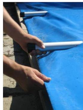
**Modèle Norwind uniquement** : si nécessaire, il est possible de déplacer les sangles côté stockage et déroulement. Pour cela, dévisser légèrement les 3 vis du patin de protection situé sous la barre, faire coulisser la sangle concernée à la position souhaitée puis revisser les vis du patin.
